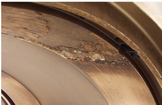
In der Vergangenheit: Lagerschaden durch Lackaufbau
